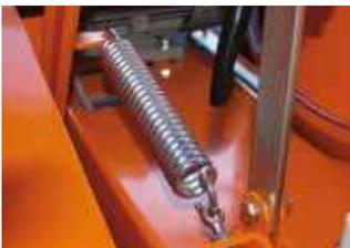
Gefederter Schneidkopf für stufenlose Höhenverstellung
