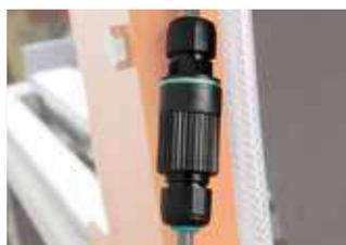
Wasserpumpe mit Schnellwechsel-Kupplung
